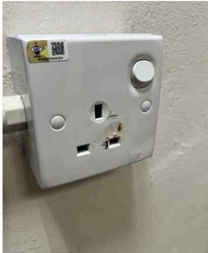
Kesan terbakar pada plug socket untuk portable air cond (yang sama pad 2 Okt) di Pejabat FKTM pada 7 Oktober.
