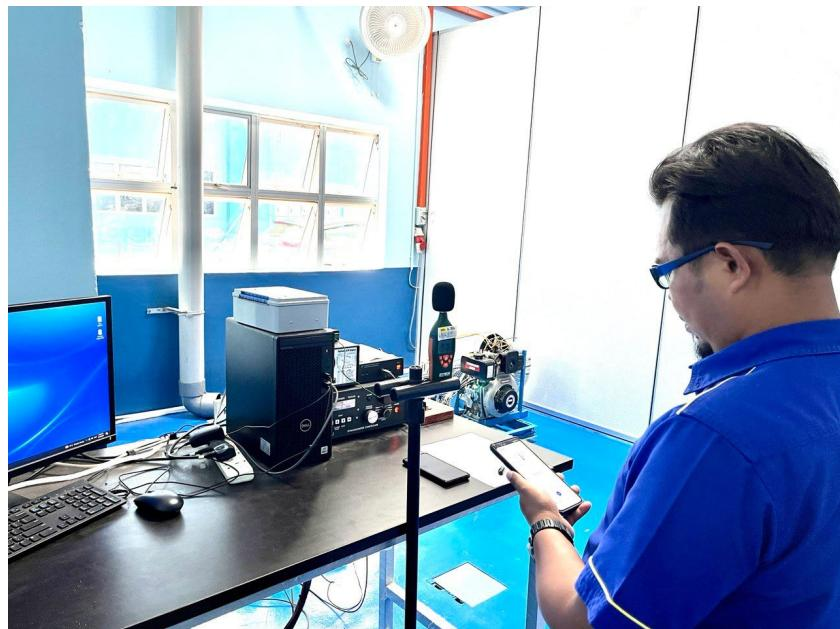
Bacaan: Jarak 5 meter dari mesin dan tempat Ujian *Engine Test Bed*
